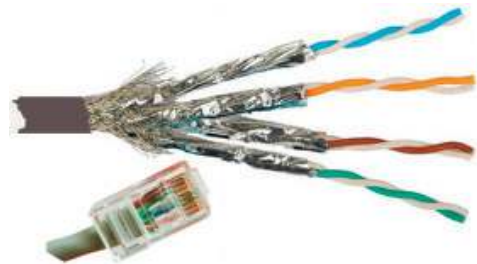
Fig. 8.3 : STP cable, RJ-45 connector
