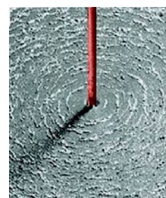
चित्र 13.6 (a) किसी विद्युत धारावाही सीधे चालक तार के चारों ओर के चुंबकीय क्षेत्र की क्षेत्र रेखाओं को निरूपित करता संकेंद्री वृत्तों का पैटर्न। वृत्तों पर अंकित तीर क्षेत्र रेखाओं की दिशाओं को दर्शाते हैं (b) प्राप्त पैटर्न का समीप दृश्य
